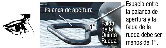
**Si la inspección visual indica que no logró obtener un acople adecuado, abra la quinta rueda, inspeccione los componentes dañados y repita la secuencia de acoplamiento**
