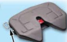
*Position verrouillée - Sur la série 6000 et 7000 No-Slack® la poignée doit être à l'intérieur de 1" du côté de la sellette.*
