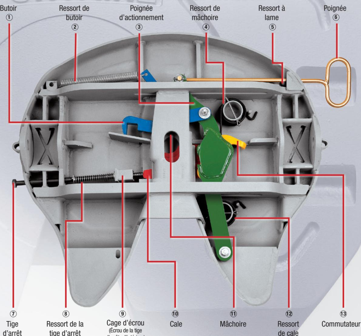
Modèle SLTPLH5092 avec ouverture à gauche démontré
